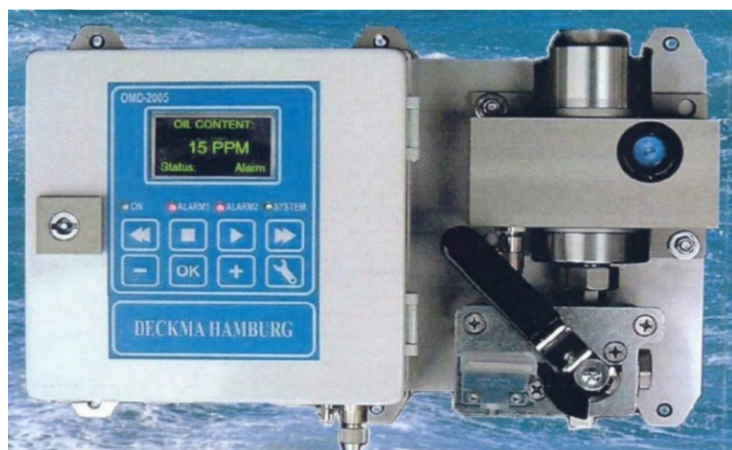
Рисунок 4.4-2 Внешний вид датчик контроля сброса очищенных льяльных вод
