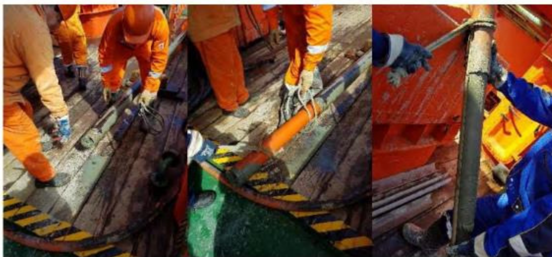
Рисунок 4.1 – Общий вид извлечения керна из пробоотборника
