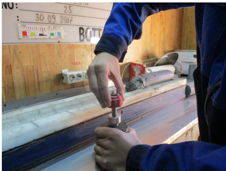
Рисунок 4.4 – Испытание микрокрыльчаткой (Torvane)
