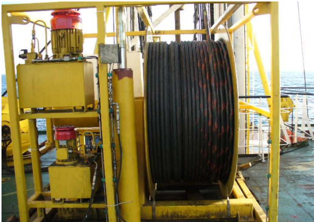
Д3.6 Снаряд для пробоотбора Wison-APB 100 kN бурового комплекса ИС «Триас»
