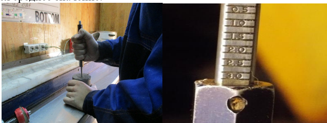
Рисунок 4.5 – Испытание пенетрометром (Penetrometer)
