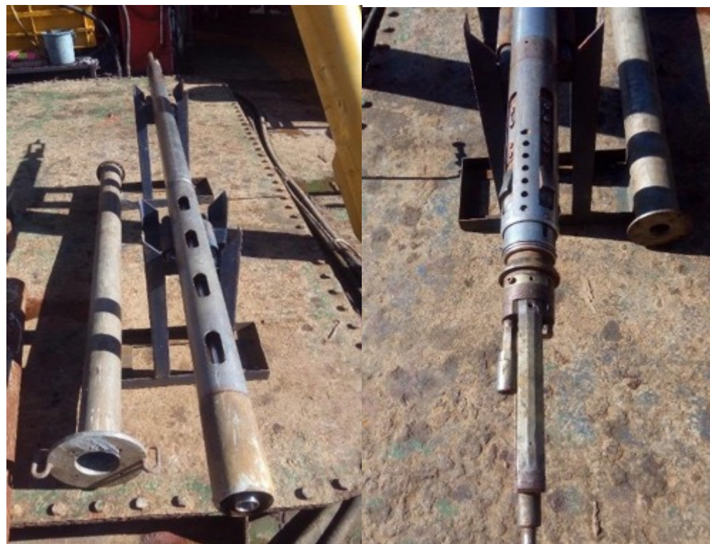
Д3.6 Снаряд для пробоотбора Wison-APB 100 kN бурового комплекса ИС «Триас»
