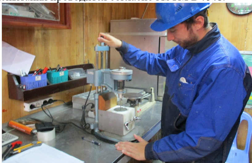
Рисунок 4.3 – Лабораторное испытание крыльчаткой (Labvane)
