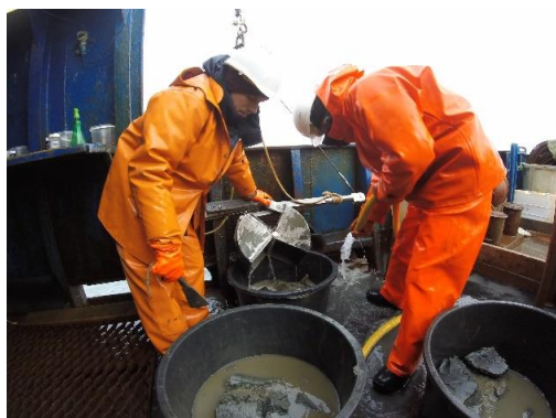
Рисунок 5.4-4– Отбор проб грунта с помощью дночерпателя Ван Вина
