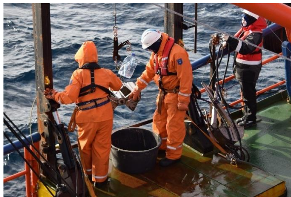
Рисунок 5.4-5-Отбор проб грунта с помощью дночерпателя Океан-0,1
