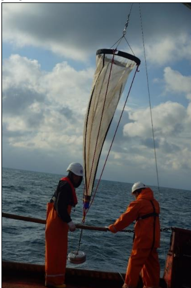
Рисунок 5.4-7 Отбор проб ихтиопланктона, сетью ИКС-80
