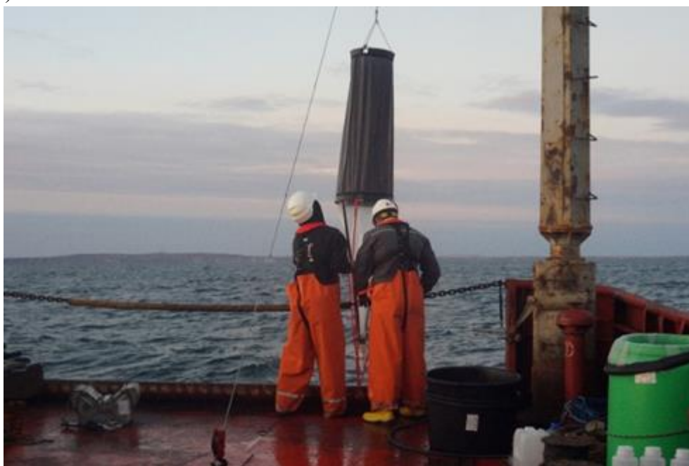
Рисунок 5.4-6 Отбор проб зоопланктона, сетью Джели
