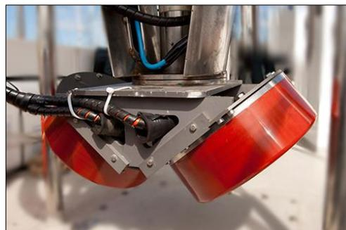
Рисунок 1.3-4 Общий вид многолучевого эхолота (МЛЭ)
